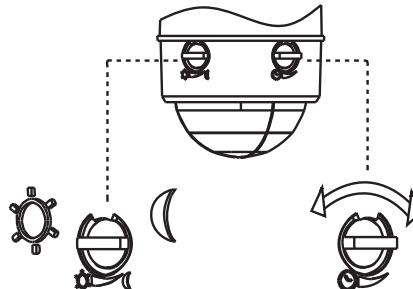
Luego de regular los ajustes TIME y LUX, gire la caperuza del detector de movimiento hacia la izquierda y alinee las flechas de la carcasa de la lámpara con las de la caperuza del detector de movimiento.
