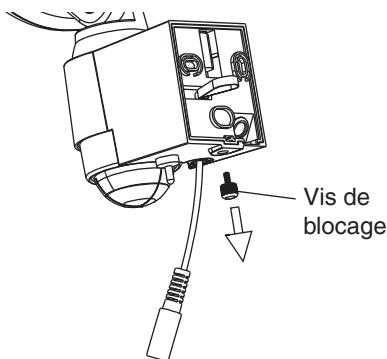
2. Appuyer sur le bouton de déclenchement de la partie arrière supérieure du logement à batterie pour dégager la plaque de montage mural de l'arrière du logement à batterie. Tirer l'onglet de la courroie noire se trouvant sur la plaque de montage mural pour la sortir du logement à batterie.
