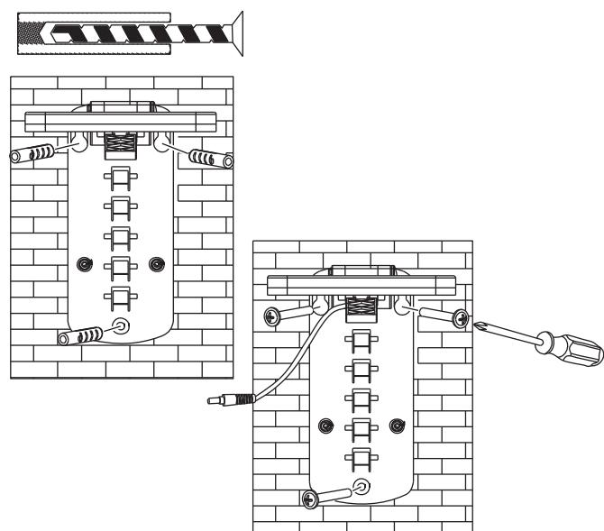
2. Ajuster l'angle du panneau solaire en déplaçant le support d'ajustement au crochet approprié sur la fixation de montage. Ne pas oublier que le panneau solaire doit recevoir autant de lumière directe du soleil que possible durant la journée. Notez bien que les ombres peuvent bloquer la lumière du soleil et l'empêcher d'atteindre le panneau solaire durant la journée.
