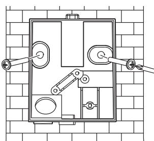
4. Coloque la parte trasera de la caja de las baterías encima de la placa de montaje en pared y presione el botón de desenganche de la placa de pared para unir a presión la caja de las baterías con la placa de pared.
