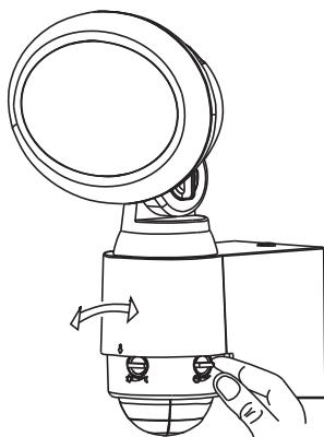
**TIME** — Tiempo de duración: El tiempo de duración se ajustará de 10 segundos a 1 minuto, dependiendo de cuánto tiempo luego de detectado el movimiento desea que la lámpara permanezca encendida. Nota: Una vez que la lámpara ha sido activada, cualquier detección adicional de movimiento hará reiniciar de nuevo desde el principio el tiempo calibrado. Gire el cuadrante TIME en sentido horario para disminuir la duración.
