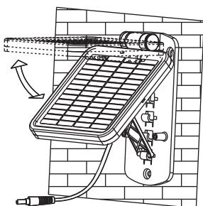
3. Guíe con cuidado el cable del panel solar hacia la lámpara. Enchufe el cable del panel solar en el conector que se extiende de la parte inferior de la caja de las baterías.
