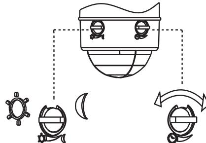
Après avoir ajusté les réglages TEMPS et LUX, faire pivoter le dôme du détecteur de mouvement vers la gauche et aligner les flèches sur le socle de la lampe et le dôme du détecteur de mouvement
