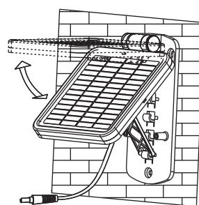
3. Acheminer soigneusement le câble du panneau solaire à l'appareil d'éclairage. Brancher le câble du panneau solaire au connecteur se trouvant au bas du logement à batterie.
